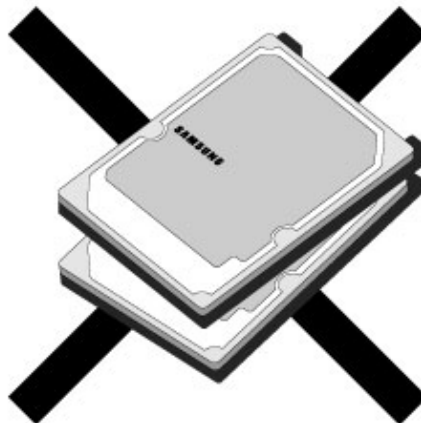
Fig. 9-3 : HDD handling guide -Do Not Stack!
